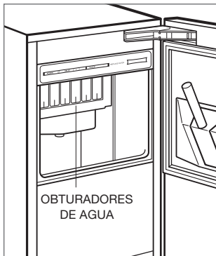
Ubicación de los obturadores de agua
