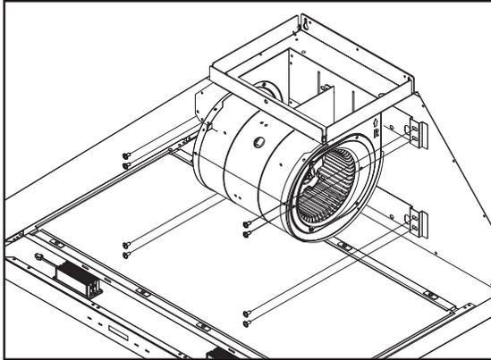
6. Fixez le moteur à l'arrière du corps de la hotte à l'aide de (8) vis 3/16" x 3/8" et rebranchez le bouchon du ventilateur.
