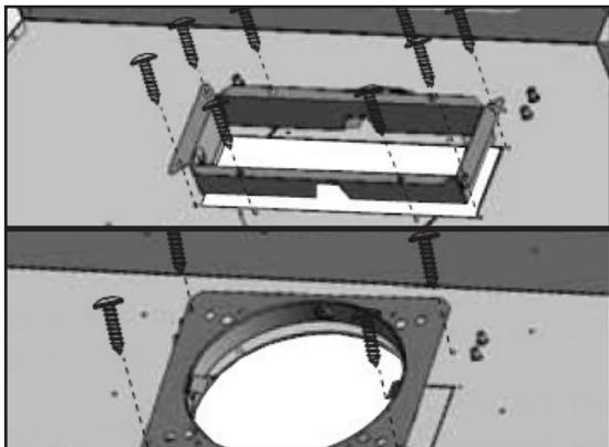
3. Fixez le collier de conduit rectangulaire ou rond à l'intérieur du corps de la hotte à l'aide de (4) vis M4 x 6 pour les rectangulaires ou (4) vis à tôle M4 x 8 pour les ronds.
