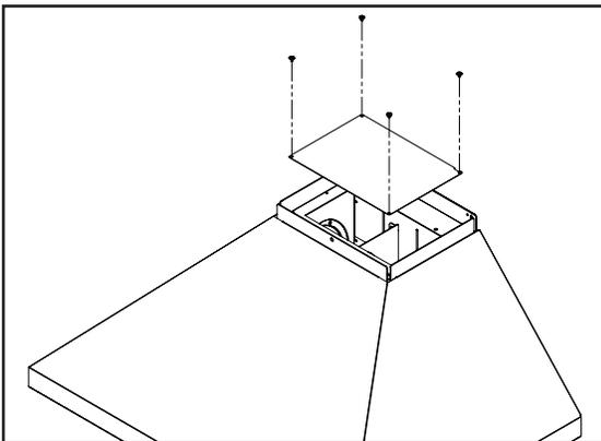
7. Depuis l'extérieur du corps de la hotte, fixez la plaque de recouvrement supérieure au haut du corps de la hotte à l'aide de (4) vis à métaux M4 x 8.
