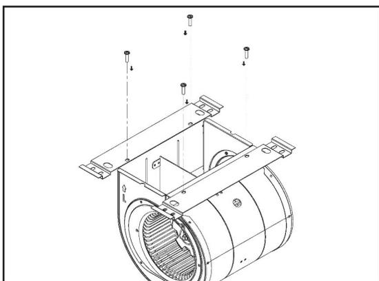
4. Fixez les supports de conduit arrière au moteur à l'aide des (4) vis précédemment retirées à l'étape 1.
