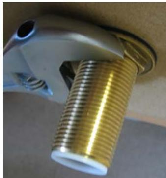
6) Remettre le caoutchouc noir et serrer le contre écrou
