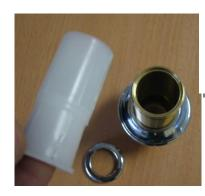
2) Enlever la bague plastique fendue *Remove the cracked plastic ring*
