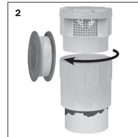
Aplique cinta de PTFE a las roscas de la válvula TurboVent. Enrosque en el adaptador. No utilice herramientas ni sellador de tuberías.
