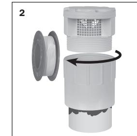
Appliquer du ruban PTFE sur les filets de la vanne TurboVent. Visser dans l'adaptateur. N'utiliser aucun outil ou pâte d'étanchéité.
