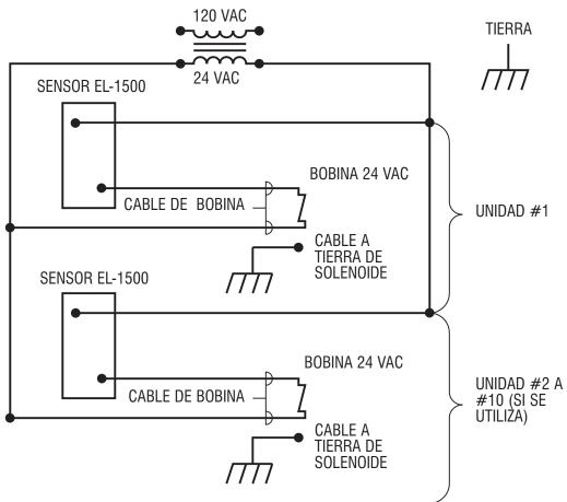
**IMPORTANTE:** Modelos Anteriores del Sensor estaban hechos con cuatro (4) Conectores de Cable. Cuando reemplace un Sensor EL-150 de cuatro (4) Cables con un Sensor EL-150 de tres (3) Cables, el Conector Negro reemplaza al Conductor Azul,
