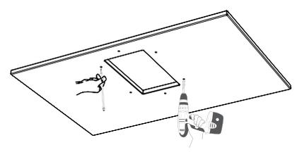
**01.** Retirez le gabarit et laissez l'évier dans sa boîte jusqu'à ce qu'il soit prêt à être installé. Placez le gabarit sur le comptoir, à l'endroit désiré. Assurez-vous que l'emplacement choisi sera libre d'obstacles, de parois d'armoires, de tiroirs et d'éléments structurels. Assurez vous qu'il y a suffisamment d'espace sous le comptoir pour installer les attaches de fixation.
