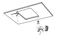
05. Sous le comptoir, identifiez et marquez l'emplacement des attaches de fixation tel qu'indiqué sur les rebords de ce plan de découpe et percez les trous en fonction d'une installation en saillie (plus bas). Insérez les chevilles des attaches de fixations.
