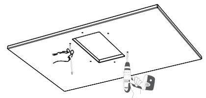
**05.** Sous le comptoir, identifiez et marquez l'emplacement des attaches de fixation tel qu'indiqué sur les rebords de ce plan de découpe et percez les trous en fonction d'une installation en saillie (plus bas). Insérez les chevilles des attaches de fixations.
