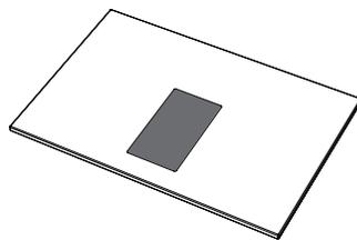
**01.** Retirez le gabarit et laissez l'évier dans sa boîte jusqu'à ce qu'il soit prêt à être installé. Placez le gabarit sur le comptoir, à l'endroit désiré. Assurez-vous que l'emplacement choisi sera libre d'obstacles, de parois d'armoires, de tiroirs et d'éléments structurels. Assurez vous qu'il y a suffisamment d'espace sous le comptoir pour installer les attaches de fixation.
