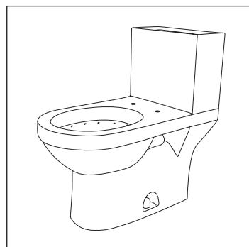
11 Raccordez à l'entrée d'eau et installez le banc. Connect to water inlet and install the seat.
