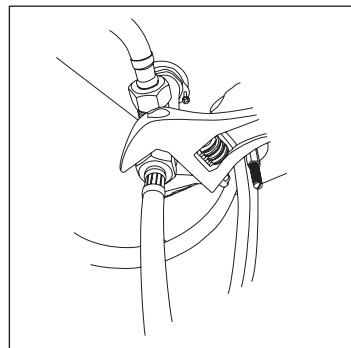
23 Fixez le flexible de raccord de la douchette à la base du déviateur. Affix the hand shower flexible coupling hose to the diverter base.
