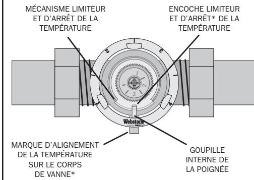
Si désiré, le réglage de la température peut être fixé sur le mitigeur Webstone en verrouillant la poignée en place :
