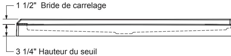
Toutes ces dimensions sont approximatives. Afin d'assurer une installation parfaite, les dimensions de la structure doivent être vérifiées à partir de l'unité
