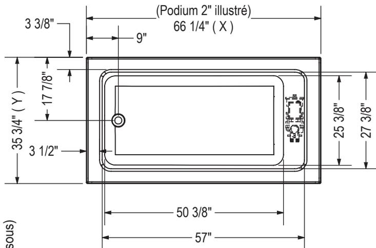
Ce dessin technique est universel pour toutes les configurations 6636. Les dimensions extérieures (X, Y) varient selon la configuration (voir tableau ci-dessous)
