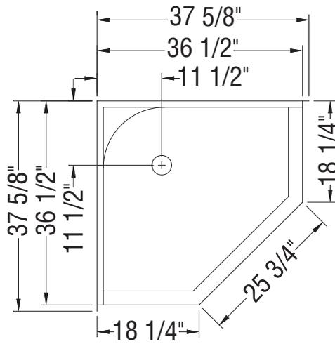
Toutes ces dimensions sont approximatives. Afin d'assurer une installation parfaite, les dimensions de la structure doivent être vérifiées à partir de l'unité.
