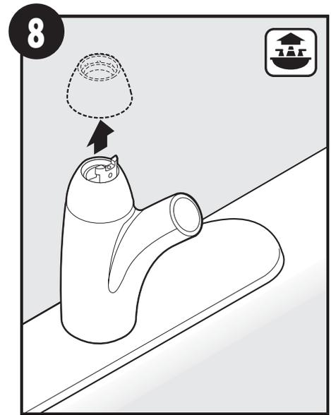
Lift up and remove handle dome. Set aside for reinstallation. Levante y retire la cúpula del monomando. Resérvela para volver a instalarla.
