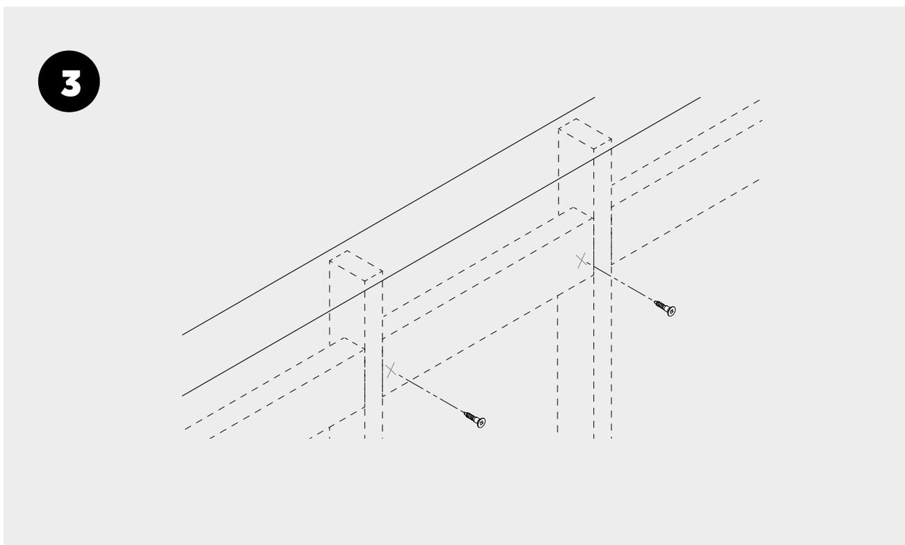
4. Utiliser les chemins de clé pour accrocher préliminairement le(s) support(s) aux vis préalablement installées.
