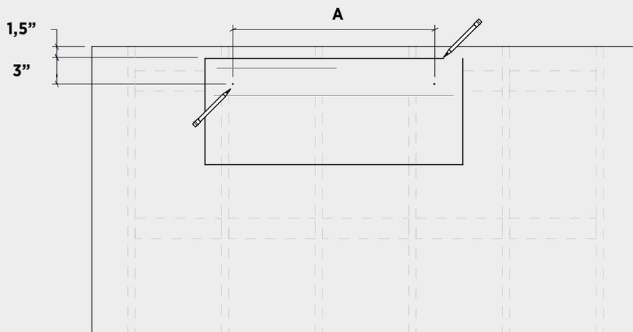
3. Visser deux (2) vis adaptées au matériau du mur (non-incluses) aux points marqués en laissant un léger espace entre la tête et le mur.
