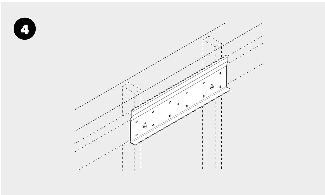
5. Dans le cas d'un module vertical, fixer la deuxième pièce de support à la distance indiquée.
