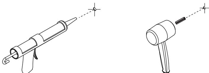
Siliconer et insérer les chevilles / Silicone and insert the wall plugs
