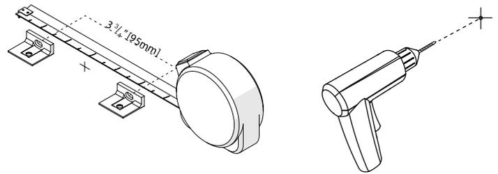
Vérifier la mesure, marque les points de perçage et percer / Check the measurement, mark the drilling locations and drill
