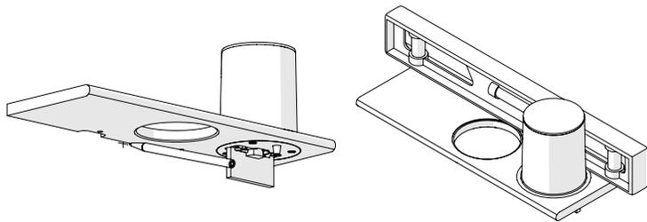
Placer la tablette sur le mur à niveau et marquer le centre / Place the shelf on the wall with a level, and mark the center
