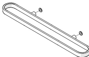
Retirer la barre et percer à travers les collants /
