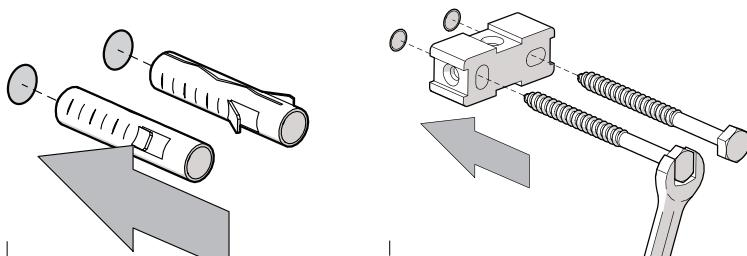
Insérer les chevilles et visser les supports de fixation au mur.
