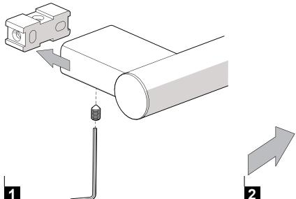
Retirer le support de fixation et insérer les embouts de marquage.
