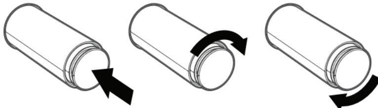
Si vous souhaitez verrouiller l'inverseur en position "douche à main", appuyez simplement sur le bouton et faites-le pivoter de 90 degrés. Faites pivoter encore 90 degrés pour déverrouiller.
