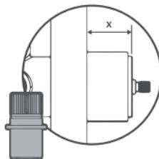
Si "x" mesure entre 42mm et 28mm utilisez l'adaptateur moyen.
