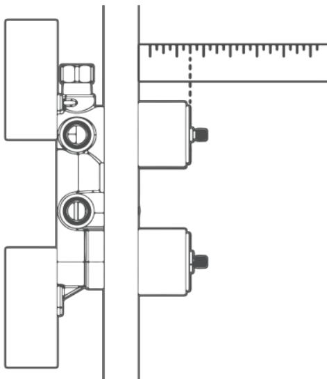
Mesurez la longueur entre le bord supérieur du manchon et la finition du mur.
