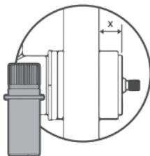
Si "x" mesure entre 28mm et 15mm utilisez l'adaptateur long.
