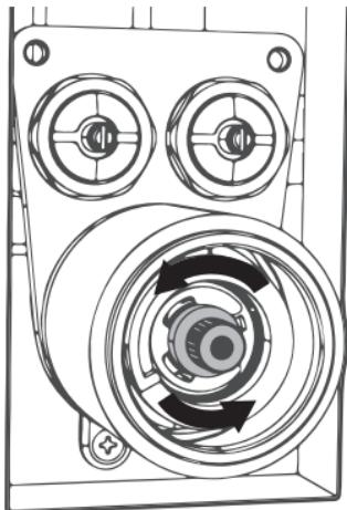
Avec l'aide d'un thermomètre, calibrer la température de l'eau sortant du bec à 48.9°C (max) en tournant la cartouche (partie grisée).
