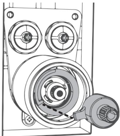
Avec la température de l'eau réglée à 48,9°C, installez l'adaptateur de manière à ce qu'il soit aligné avec le limiteur en plastique. Bloquant la rotation anti-horaire de la cartouche.
