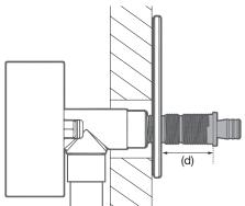
7b Couper la tige filetée à l'arrière (dans une des encoches), afin d'enlever la longueur mesurée (d). Ebavurez l'extrémité coupée du cylindre.
