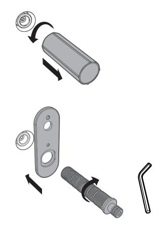
7a Mettre en place le cylindre fileté et mesurer la distance (d) entre la plaque de finition et la lèvre.
