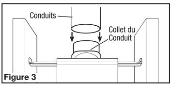
Assurez-vous que les joints des conduits et les pénétrations extérieures sont scellés avec du mastic ou tout autre matériau similaire pour créer un passage d'air étanche afin de minimiser la perte ou le gain de chaleur et réduire le risque de condensation. Placez / enveloppez l'isolant autour du conduit et / ou ventilateur afin de minimiser la possibilité d'accumulation de condensation à l'intérieur du conduit, ainsi que la perte ou le gain de chaleur (Figure 4).
